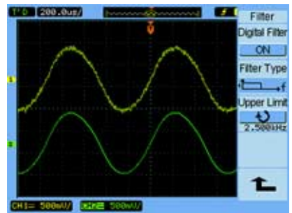
图9. 使用低通滤波器将通道 1 中被噪声干扰的波形 (黄色) 整形为通道 2 中的干净波形 (绿色)。
